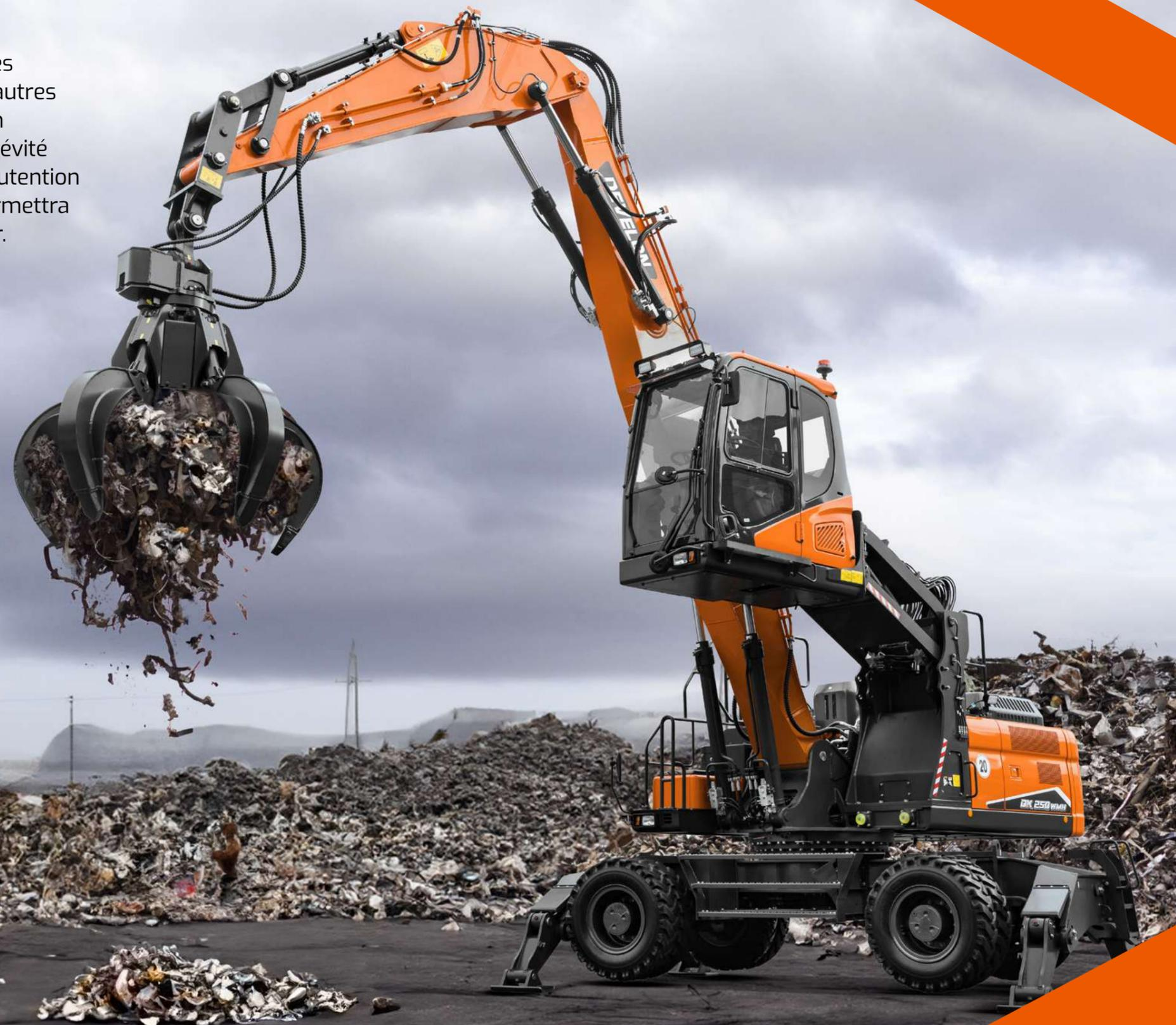
Conçues pour la ferraille, les déchets solides, les matières recyclables et autres matériaux en vrac, les pelles de manutention Develon offrent d'excellentes forces hydrauliques ainsi qu'une puissance et un couple élevés pour déplacer des montagnes de matériaux. La puissance du balancier vous permet de traiter des volumes accrus de matériaux avec rapidité et précision, jour après jour.
