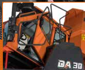
Mains courantes extérieures tout autour de la cabine
